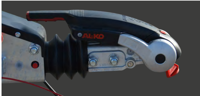
Abklappbare Stütze und Deichsel MK4 Antischlingerkupplung für PKW Betrieb
